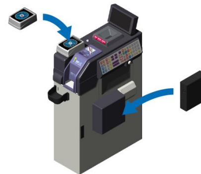
ICカードユニットの交換 (運賃箱の改造)
