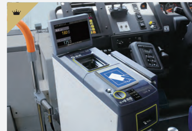
運賃箱 ICカードリーダ Farebox Smart Card Reader
