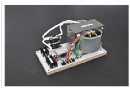
基地局向け耐雷トランス
