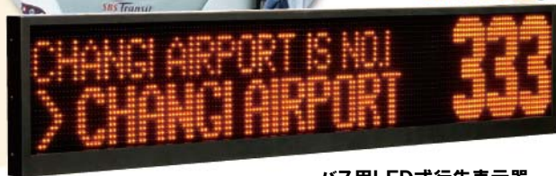
バス用LED式行先表示器 (シンガポール向け)
