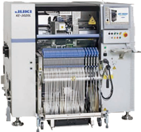
実装機 / JUKI KE-3020RL 0402 ±40 μm 0402 以外 ±50 μm
