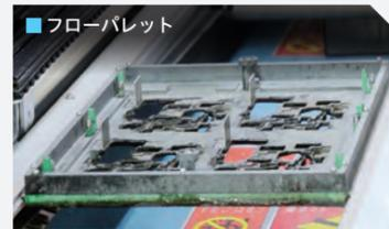
チップ面を保護してフロー槽にてはんだ付けができる治具を作成しますので、ご相談ください。
