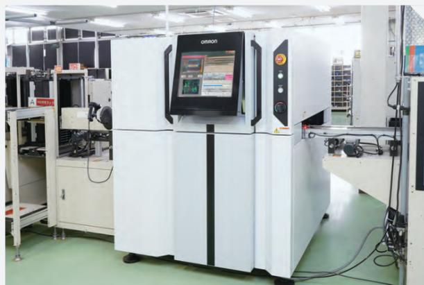
実装後の基板・はんだ付け箇所は検査を標準対応しています。3D検査機的应用・品質管理にて外観不良を逃しません。
